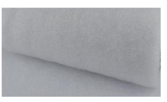
PP夹芯材料由聚丙烯短纤维针刺而成,是夹芯缝编复合毡的主要原材料,主要应用于轻质RTM,真空辅助RTM等成型工艺中。
