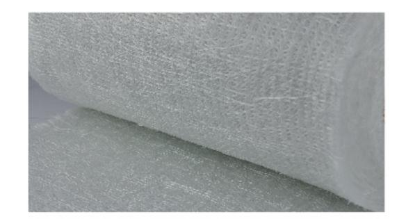
众杰玻璃纤维针织毡是把玻璃纤维直接纱短切成一定长度,呈无序排列,以聚酯缝编线缝编而成,可跟无纺布以及碳纤维表面 毡复合。适用于各种树脂增强系统,如不饱和聚酯树脂,乙烯基树脂和环氧树脂等。广泛应用于拉挤、缠绕、RTM、手糊工艺 等成型产品,如拉挤类板材、型材、棒材,管道内衬,储罐,汽车部件,造船,绝缘板,静电除尘阳极管及其他玻璃钢制品。
