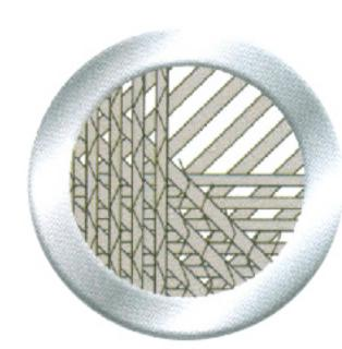
众杰玻璃纤维多轴向织物是由无碱玻璃纤维直接纱在0°,90°,+45°和-45°方向排列后以聚酯缝编线缝编而成,可选用短切原 丝层加工成多轴向经编复合毡。适用于各种树脂增强系统,如不饱和聚酯树脂,乙烯基树脂和环氧树脂等。广泛应用于真空,手 糊,拉挤,RTM等成型产品,如船体,风电叶片,汽车部件,运动器材,大型容器及其他玻璃钢制品。
