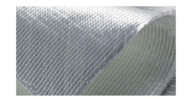
众杰玻璃纤维多轴向织物是由无碱玻璃纤维直接纱在0°/+45°/-45°或+45°/90°/-45°方向排列后以聚酯缝编线缝编而成, 可选用短切原丝层加工成多轴向经编复合毡。适用于各种树脂增强系统,如不饱和聚酯树脂,乙烯基树脂和环氧树脂等。广泛应 用于真空,手糊,拉挤,RTM等成型产品,如船体,风电叶片,汽车部件,运动器材,大型容器及其他玻璃钢制品。
